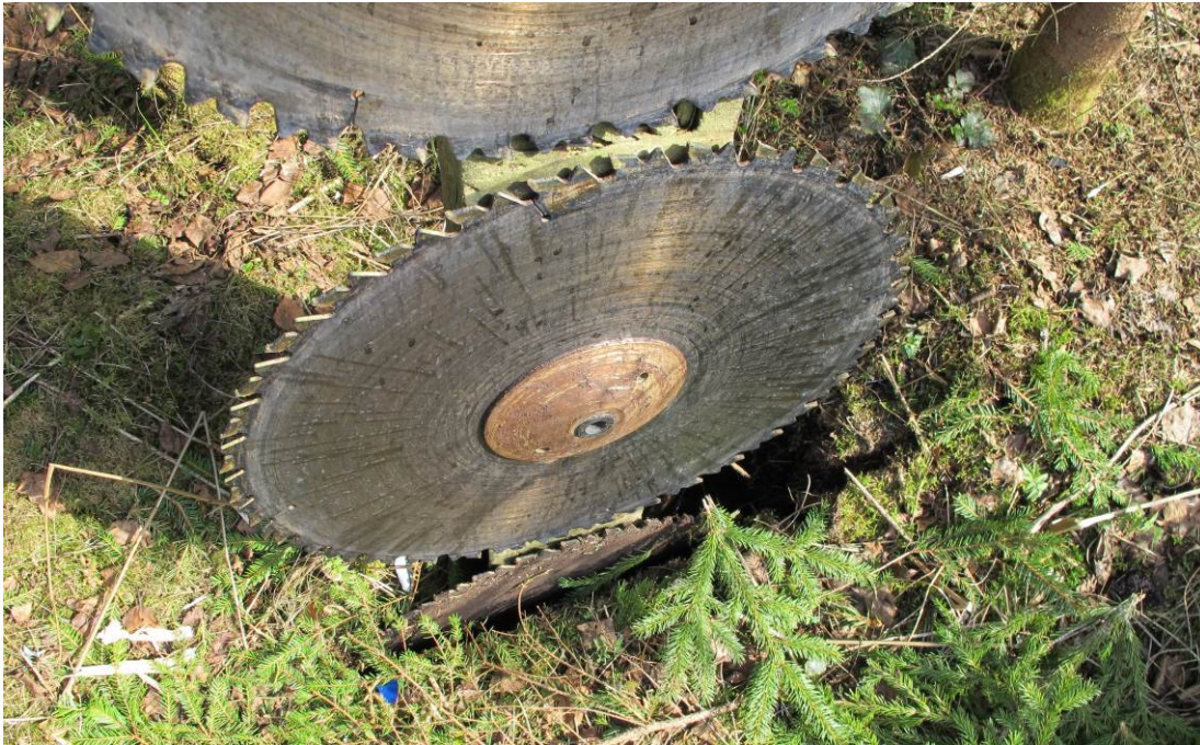
Kuva 11. Saha upposi maahan pystysuoraan kolmen terän halkaisijan mitan eli noin yhden metrin.
