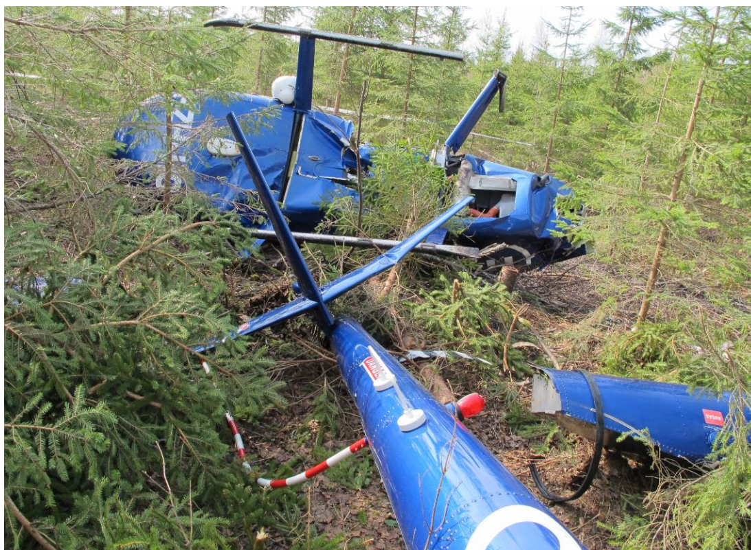
Kuva 6. Helikopterin pyrstörunko irtosi kokonaan helikopterin rungosta.
