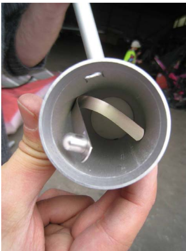
Kuva 4. Siiven kierron säätävän muovitulpan lukituspala.
