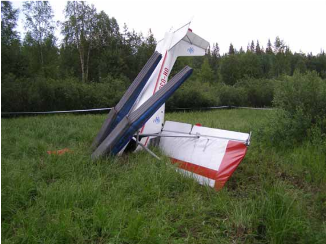
Kuva 2. Lentokone oli syöksynyt maahan lähes kohtisuoraan.
