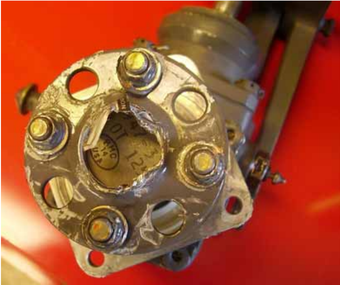
Kuva 3. Pyrstöroottorin katkenneen voimansiirtoakselin kiinnitysleikka
