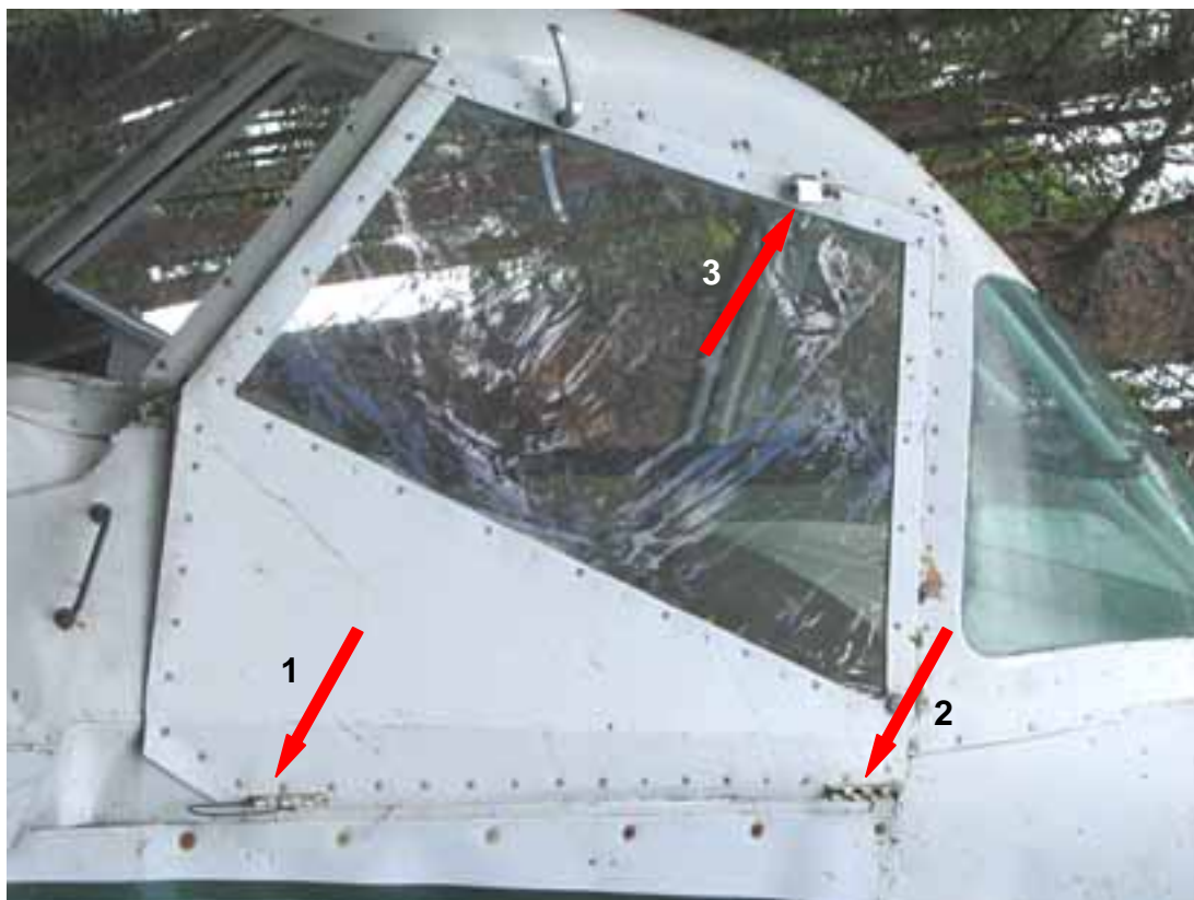
Kuva 3. Vasemman oven puutteellinen kiinnitys onnettomuuskoneessa
