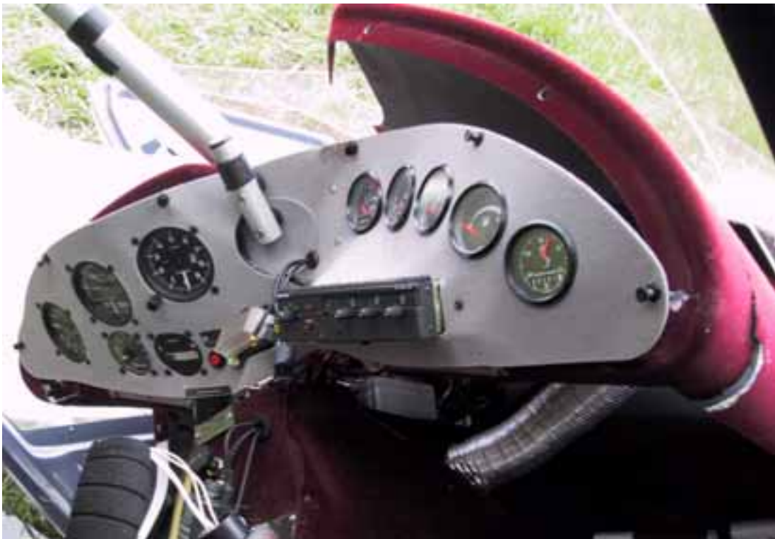
Kuva 4. Mittaritaulun yläreuna ja muotosuojus törmäyksen jälkeen
