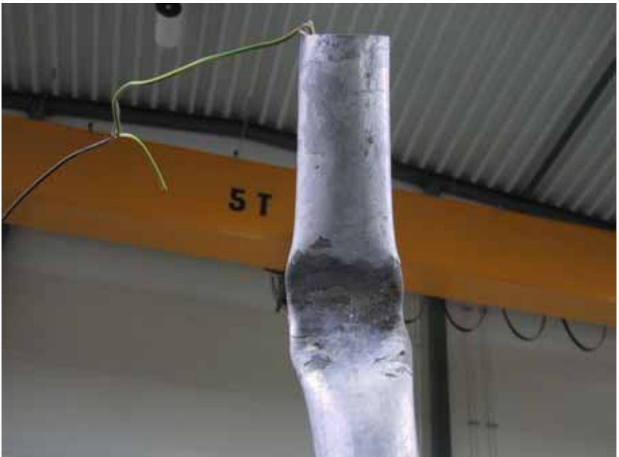
Kuva 9. Osumakohta iskemäsuunnasta kuvattuna, jolloin molempien lapojen jäljet näkyvät
