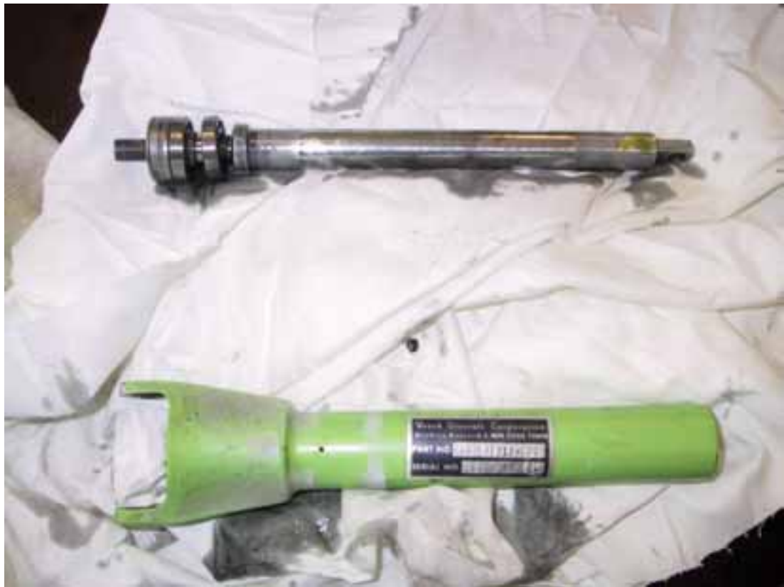
Kuva 5. Beechcraft A 36 lentokoneen peruskorjausjakson käynyt kierrekäytin avattuna
