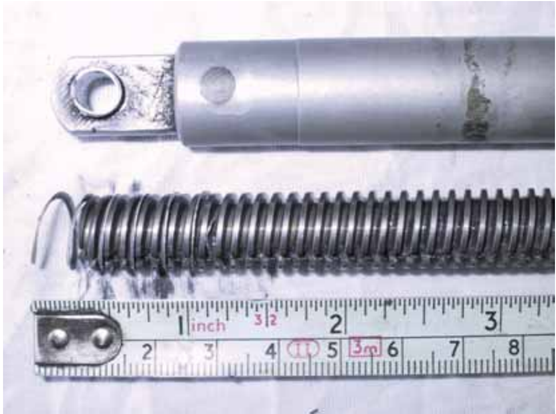
Kuva 3. Vasen liikeruuvi ja irronnut kierre
