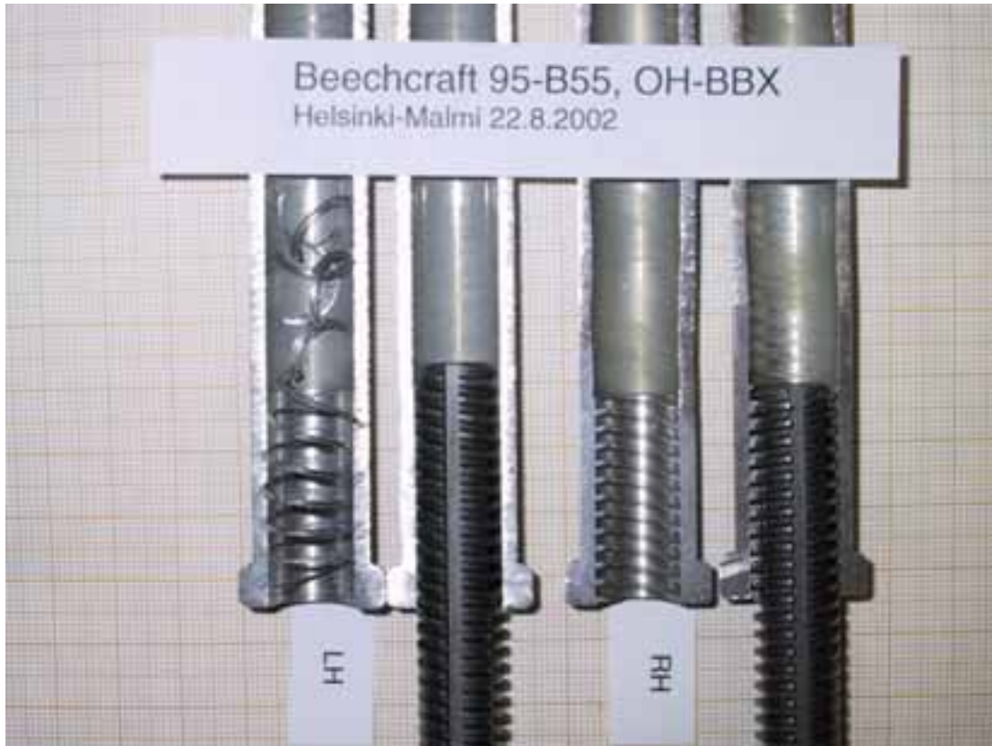
Kuva 4. Liikeruuvit ja niiden mutteriosat halkisahattuna
