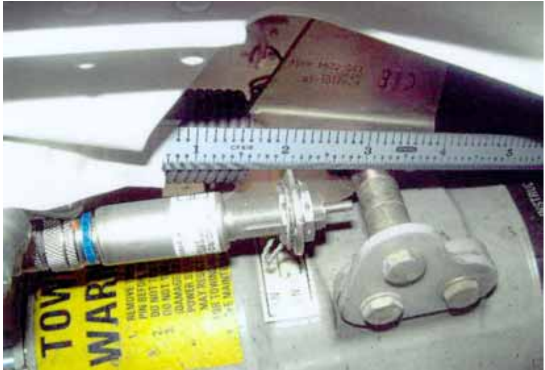
Kuva 8. Nokkatelineen ylälukitus kuvattuna vikatilanteessa
