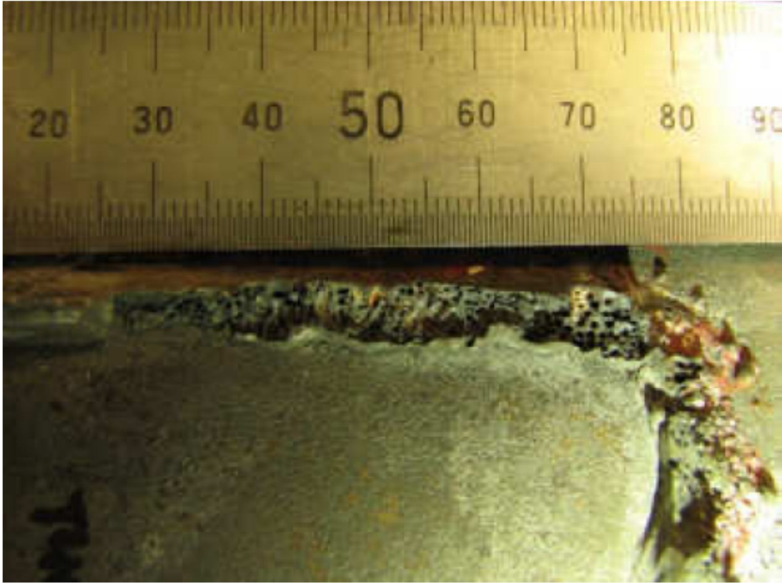
Kuva 12. Haurasta hitsiä puolet hitsin pituudesta. (kuva: Lappeenrannan teknillinen yliopisto)
