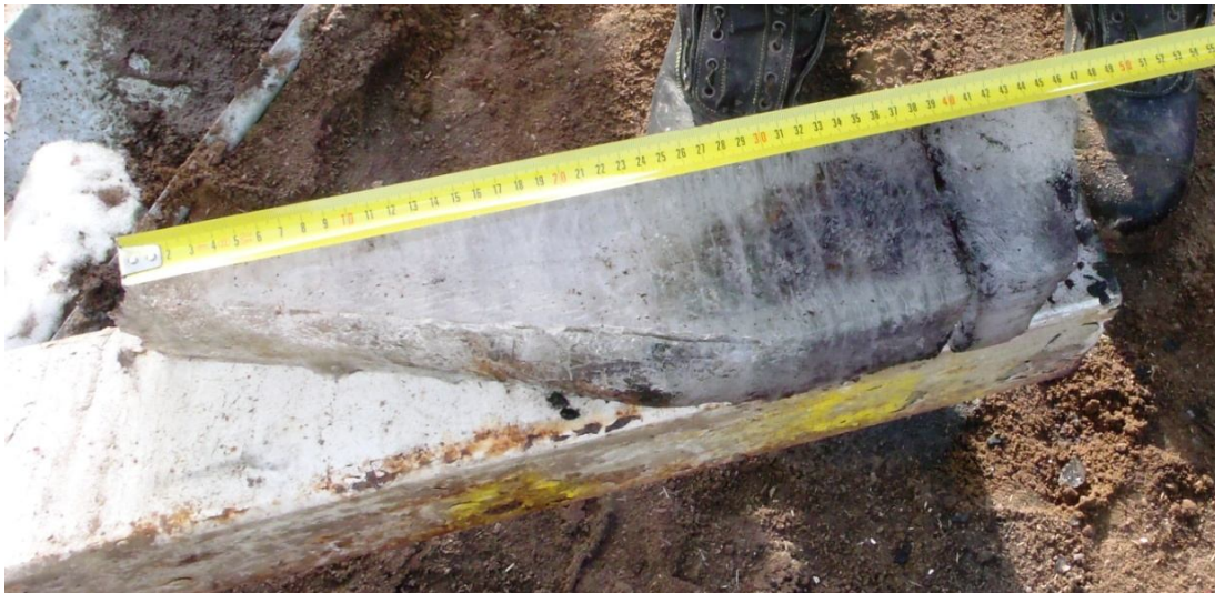
Kuva 10. Alapaarteen jääkertymä (musta viiva on leikkauksen aiheuttama pintasula).
