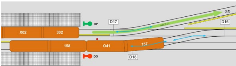
Kuva 5: Ilman käyttöliittymässä olevaa vikaa kulkutie DP-LZ olisi toteutunut ”yläkaukutta”. Punainen piste kuvassa on vaihteen rajamerkki. (Kuva: OTKES)
