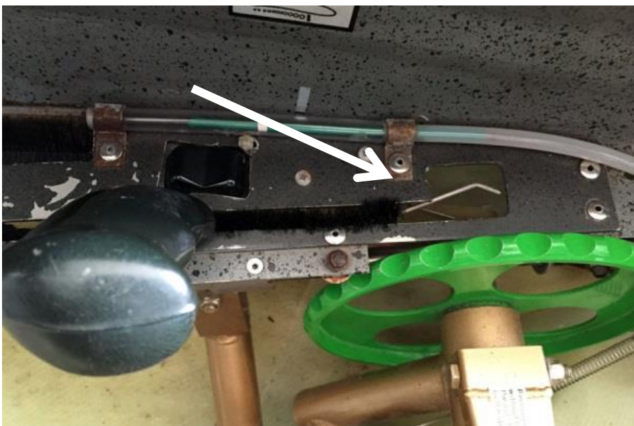
Figur 3. Den vita pilen visar styrspåret för bromsreglaget i det infällda läget. Jämför med den snedskurna plåten i bilden nedan. Foto: Henrik Svensson.
