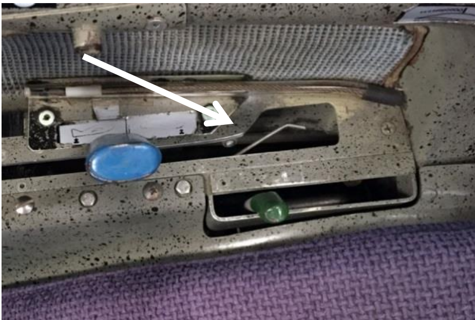
Figur 4. Bilden visar utförandet i senare modeller av LS6 bromsreglagets styrspår. Foto: Henrik Svensson.
