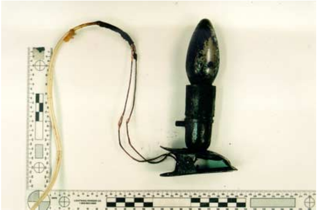
Kuva 5. Palaneessa asunnossa ollut lukulamppu rekonstruoituna palon jälkeiseen tilaan ennen johdon katkaisemista.
