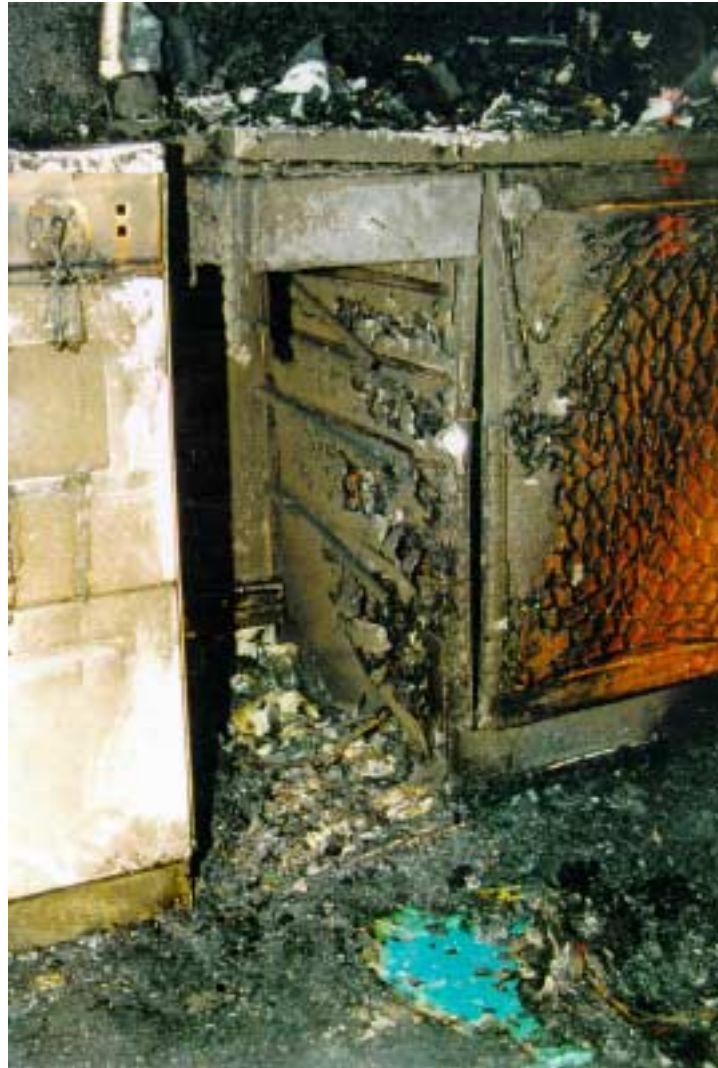
Kuva 2. Vetolaatikosto, jonka ylimmän laatikon nupissa roskapussi riippui, paloi täysin. Laatikoston edessä lattialla palanutta paperia ja sinivihreän roskapussin jäänteitä.
