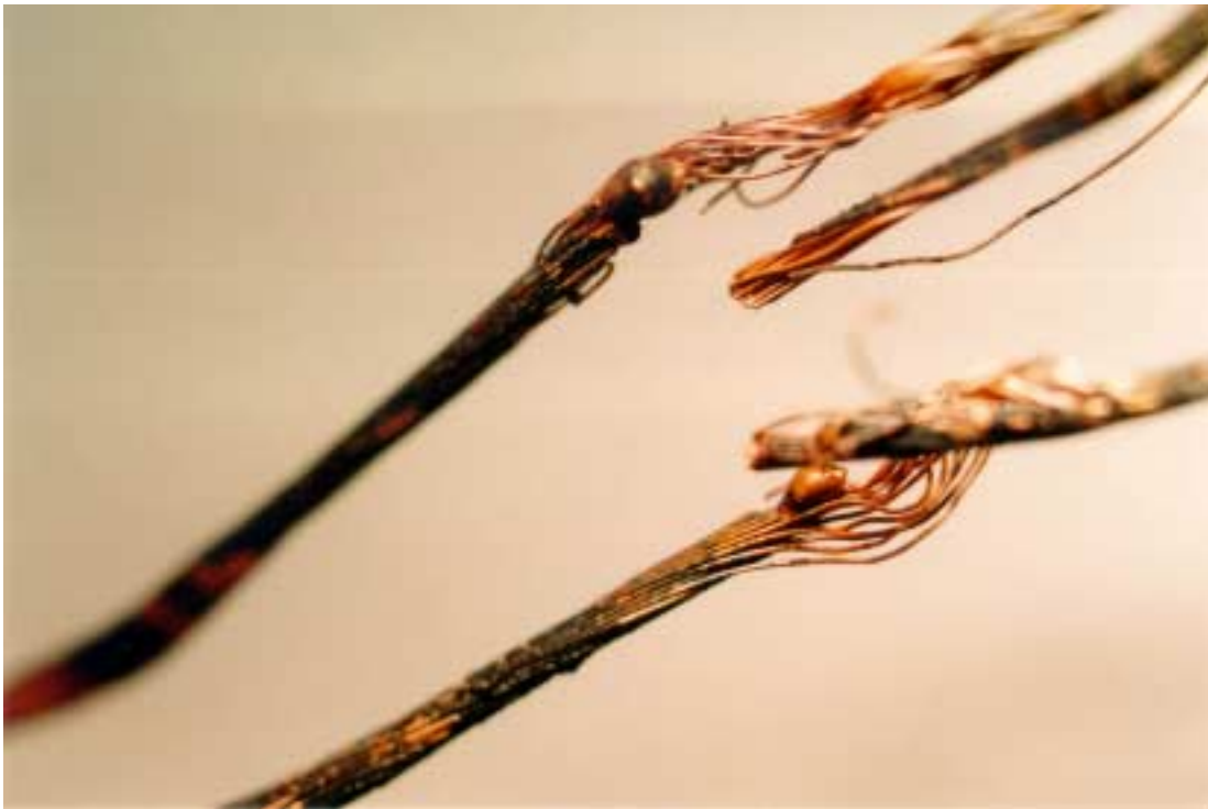
Kuva 4. Helmimäinen sulamisjälki paljaassa lampun johtimessa.
