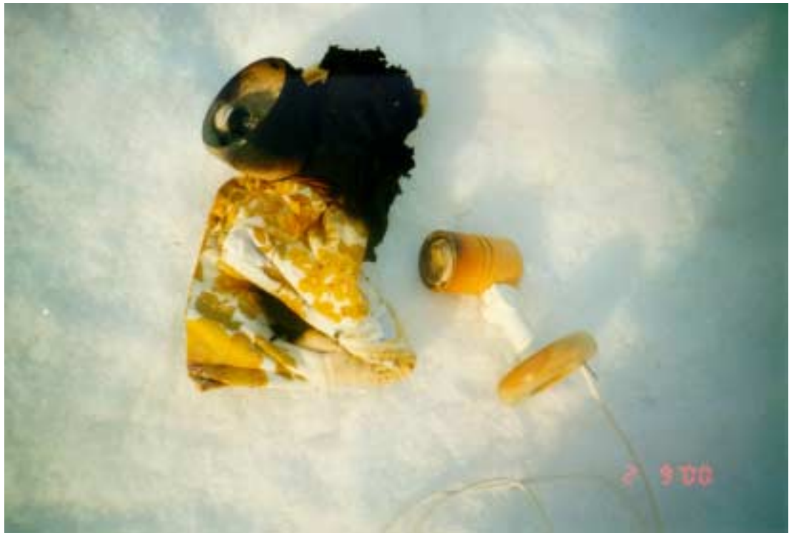
Kuva 2. Vaaratilanteen aiheuttanut valaisin kuvattuna lumihangella tapahtuman jälkeen. Valaisimen runko-osa on erillään ja lamppu varjostimineen hiiltyneen pyyheliinan sisällä.
