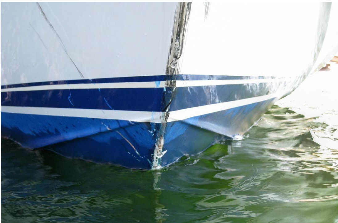
Kuva 8. NINAMARIA II:n keula törmäyksen jälkeen (P/V PAROC:n henkilöstön otama kuva).
