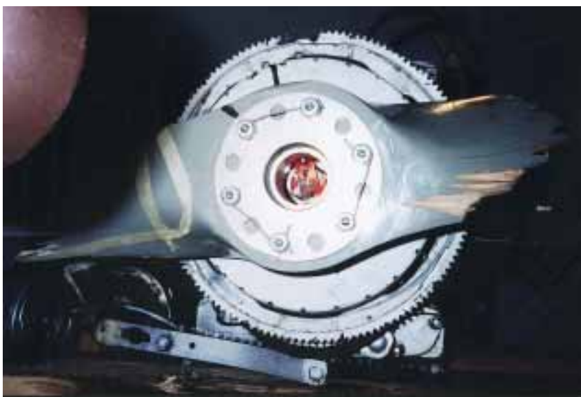
Kuva 3. Potkurin kiinnityspulttien varmistus
