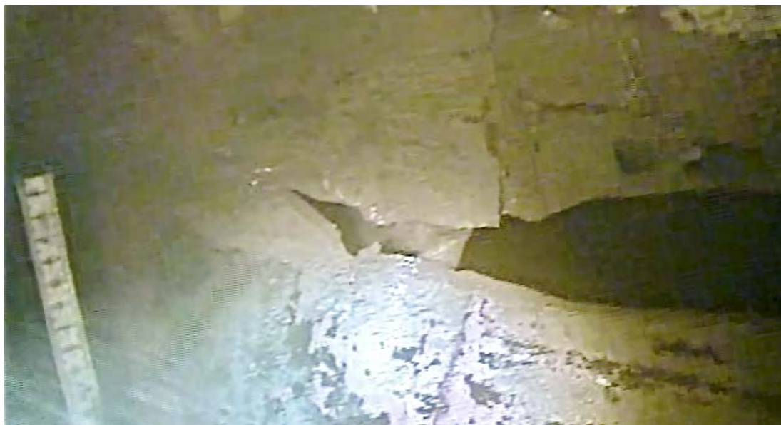
Kuva 11. Viillosreikä aluksen vasemmalla puolella keulapotkurin edessä. Reiän mitat noin 90 x 700 mm. (© Rannikon Sukelluspalvelu Oy)
