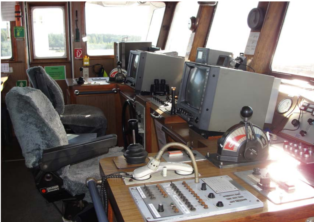
Kuva 3. TRADERin komentosilta. Kuvassa näkyy kaksi erillistä ohjauspistettä NFU-ohjausvipuineen ja konekäskynvälittimineen. Ohjauspisteiden välissä on FU-käsiruori.
